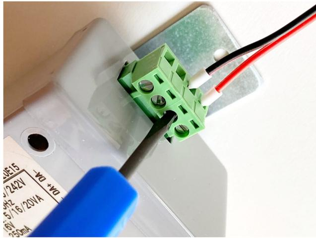
ここは、フェルール端子の先端を穴に挿し込んでネジで締めます。
